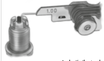
La bujía ilustrada tiene una calibración de 1.0 mm
